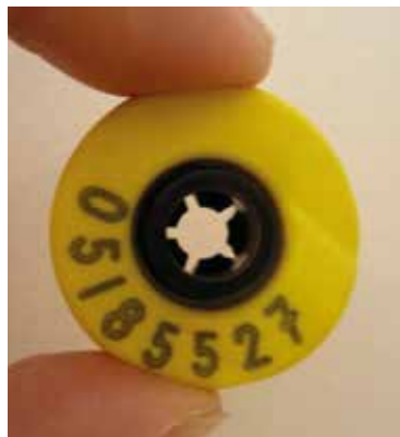
Transponder zur sicheren Pferde-Identifikation
